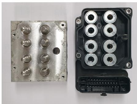
Photo. 1 ABS(Anti-Lock Brake System) module
